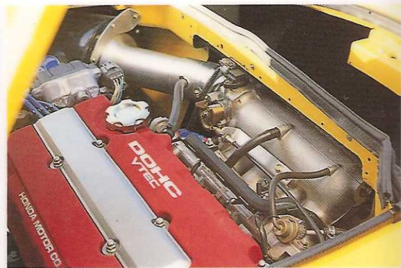
ぴったりとエンジンベイに収まるB18C。将来的にはニューインテグラ・タイプR用も搭載されるはず。テスト時には圧縮比を10.6から11.3に高めて、フライホイールを軽量化した。
